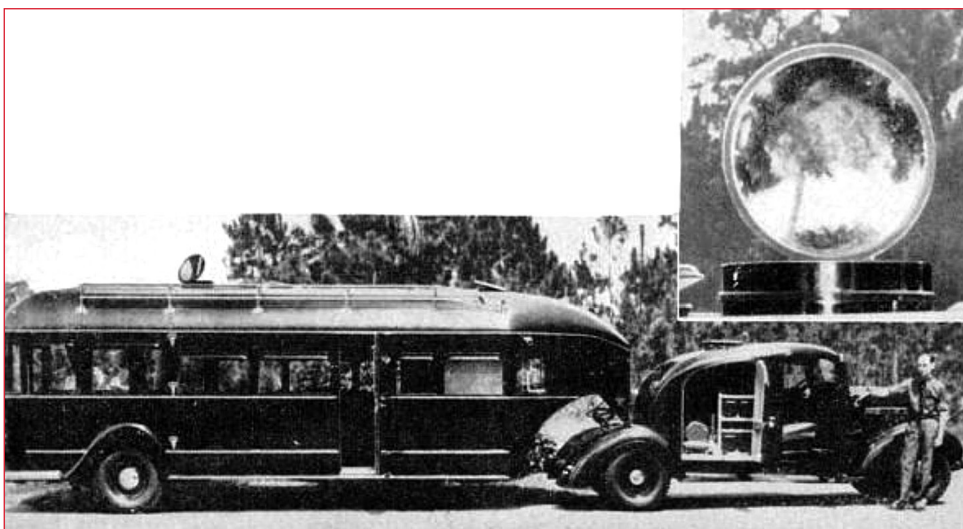
Figura 13. Trailer diseñado por un paciente para realizar tours en él. Al costado, el detalle del periscopio con espejos que se encontraba en la parte superior para poder apreciar el paisaje.
